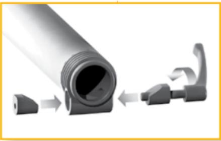
**4** Nur bei Erstmontage notwendig. Klemme an Kragarm montieren: Fügen Sie die Klemmhebel in die Führung ein.
