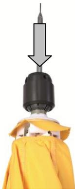
8. Stecken Sie die Nabe des Schirmdaches in den Kragarm und drehen Sie das Schirmdach dann um 90° (Viertelumdrehung) bis die zwei Zentrierbolzen in den Nuten einrasten. Dadurch bleibt das Schirmdach am Kragarm hängen.
