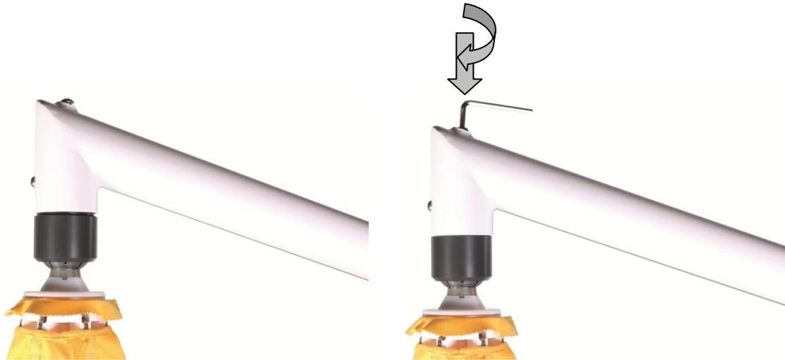
10. Öffnen Sie den Expander der Bespannung. Ziehen Sie das Schirmdach an den Speichen leicht auf, so dass der Innenraum zugänglich ist. Drücken Sie mithilfe eines Inbusschlüssels den Querbolzen bis Anschlag aus der Kugel.
